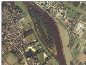
georeferenziertes und entzerrtes Luftbild = Orthophoto
