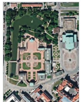
Damit in einem Luftbild beispielsweise wie in einer Karte gemessen oder dieses Luftbild einem digitalen Informationssystem hinterlegt werden kann, muss das Luftbild unter Berücksichtigung der Geländeneigung entzerrt und ein Bezug zu einem Koordinatensystem hergestellt werden. Solch ein entzerrtes und georeferenziertes Luftbild wird Orthophoto genannt.
